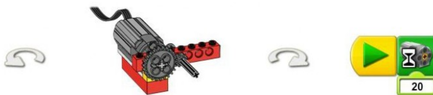
Рис. 5. Модель и программа для изучения повышающей зубчатой передачи
