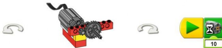
Рис. 4. Модель и программа для изучения понижающей зубчатой передачи
