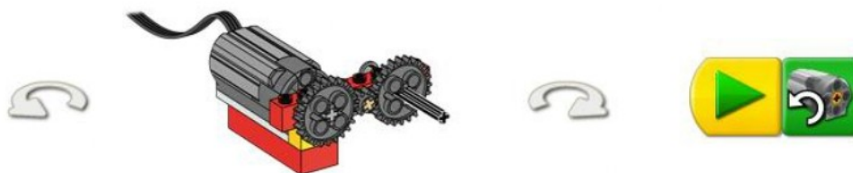
Рис. 3. Модель и программа для изучения промежуточной зубчатой передачи
